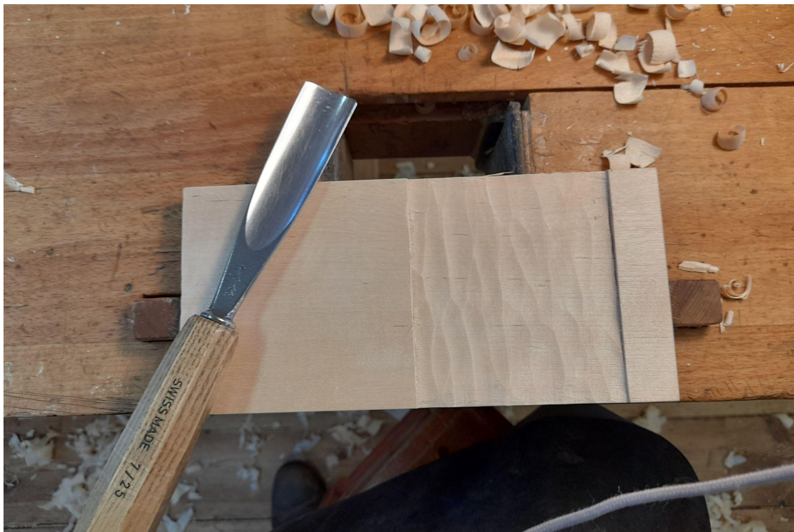
Bild 2. Här har jag tagit ut majoriteten av det extra materialet från spjälorna med en skölp.
