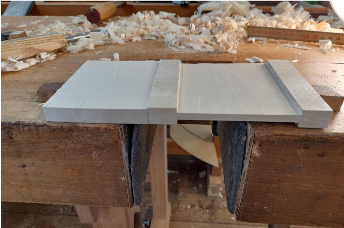
Bild 3. Sidoprofil av bandgrinden när materialet för spjälor och materialet på ovansidan av den genombrutna dekoren är borttaget.
