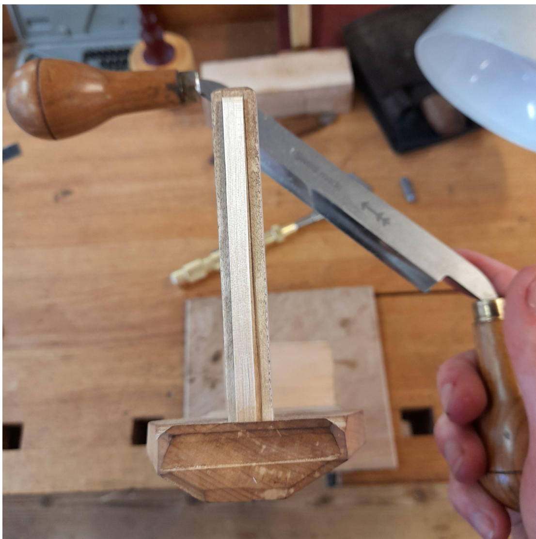
Bild 4. Täljning av tinnar med ställning
