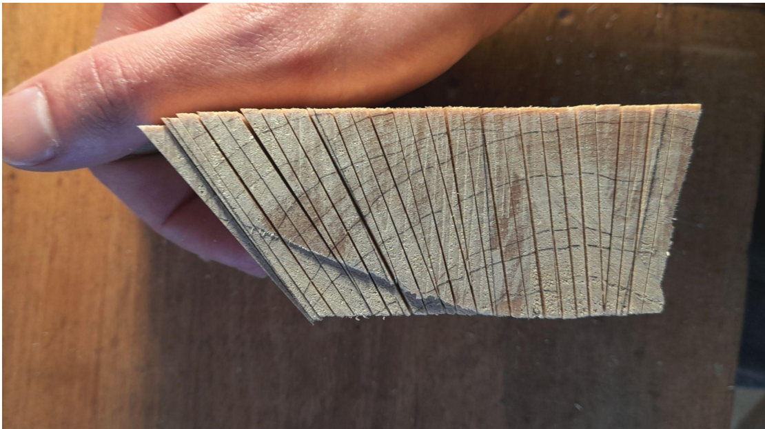
Bild 2. Kluvna brickor till tinnar
