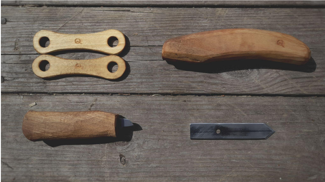
Bild 2. Några av de verktyg som har tillverkats för vävskedsmakeri under projektet
