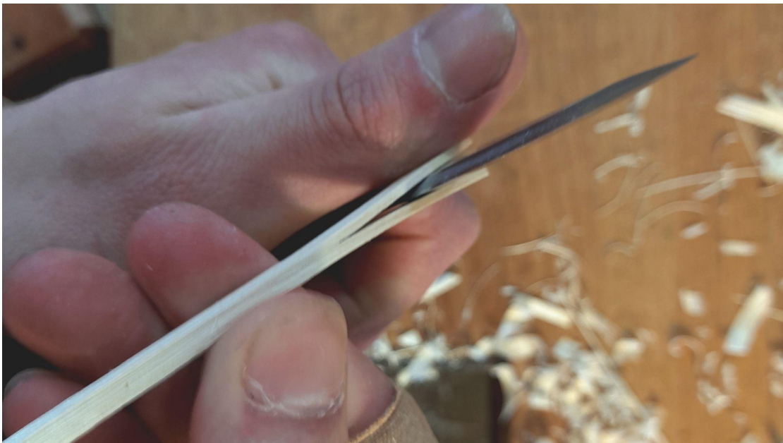
Bild 3. Klyvning av en stav till flera tinnar
