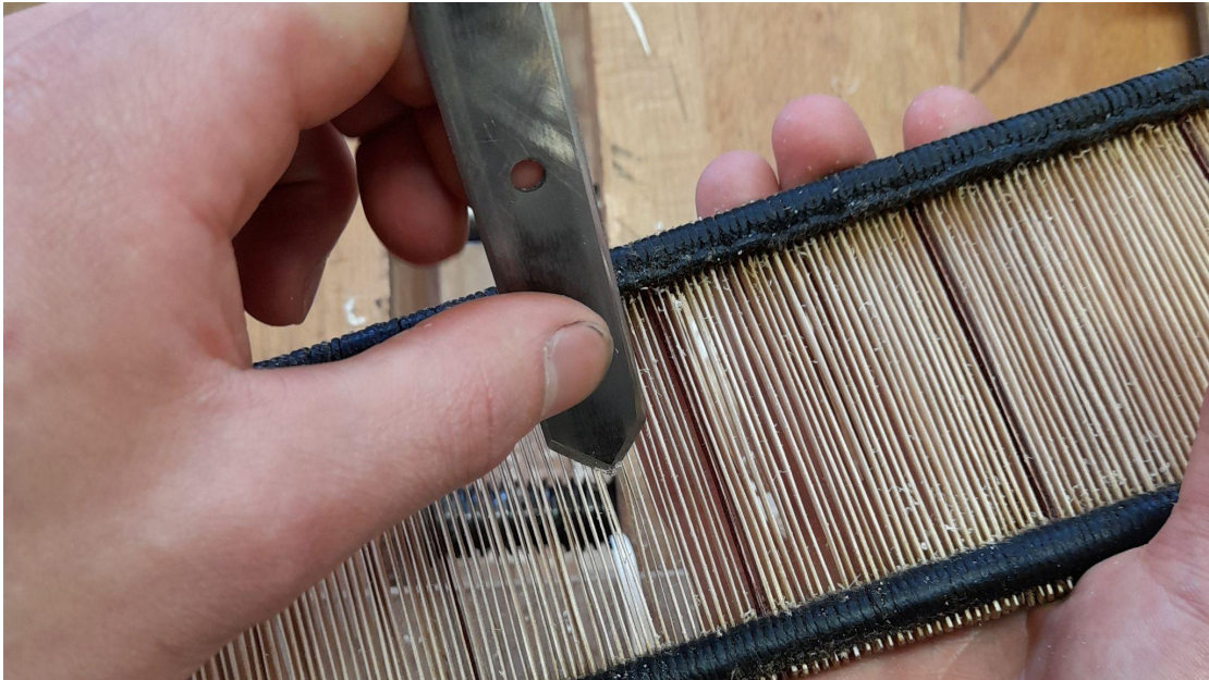
Bild 8. Sickling av tinnar
