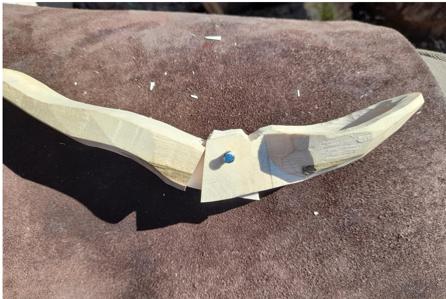
Bild 9. Tapp/slitsdelar med tillfällig axel som inte går att vika
